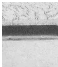
Abb. 2. Dünnschnittmikrophotogramm eines diffundierenden Farbbildners.
